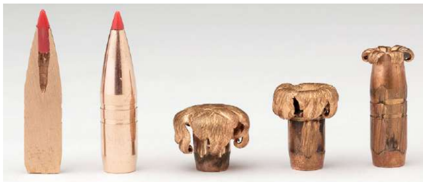
Ryc. 9. Grzybkowanie nowoczesnych pocisków kalibru 7,62 mm, w zależności od prędkości przycelnej (fot. M. Czerwiński)
