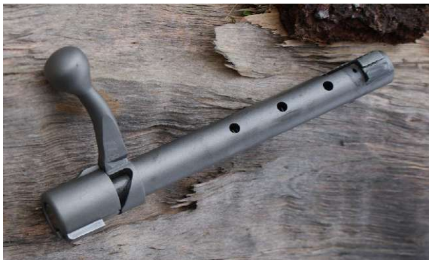
Ryc. 7. Zamek czterotaktowy sztucera Howa M1500, widoczne gazowe otwory bezpieczeństwa (fot. M. Czerwiński)
