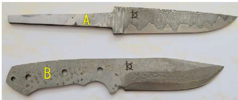
Ryc. 15. Klinga full tang (A) oraz hidden tang (B) (fot. D. Knap)
