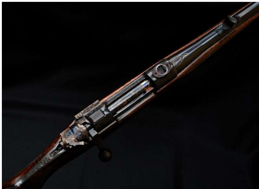
Ryc. 6. Sztucer powtarzalny z czterotaktowym zamkiem – produkcja Ferlach (fot. M. Czerwiński)
