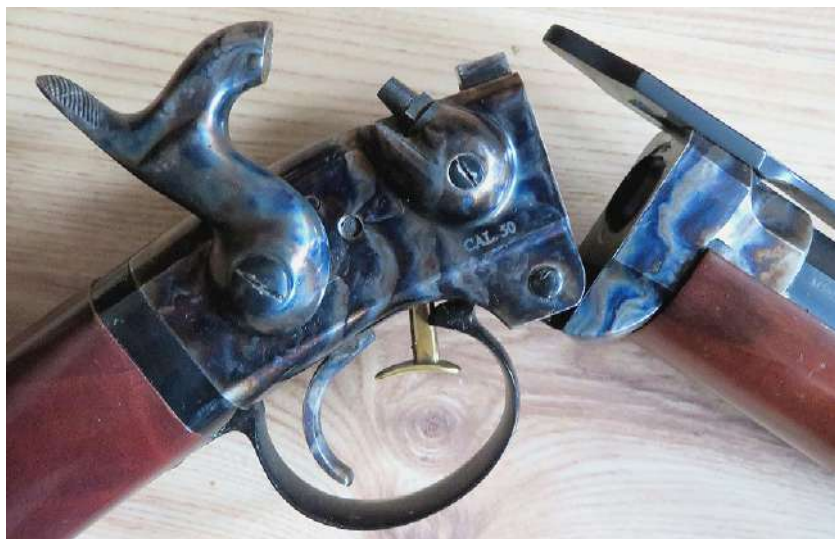
Ryc. 14. Karabin kapiszonowy Smith .50 po złamaniu (fot. D. Knap)
